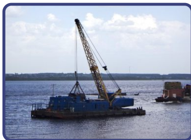
Плавкран грейферно-крюковой проект - ЛС-41, тип - топлякоподъемник
